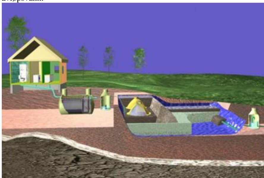
Fig. 4: Prinsippkisse av et filterbedanlegg.
